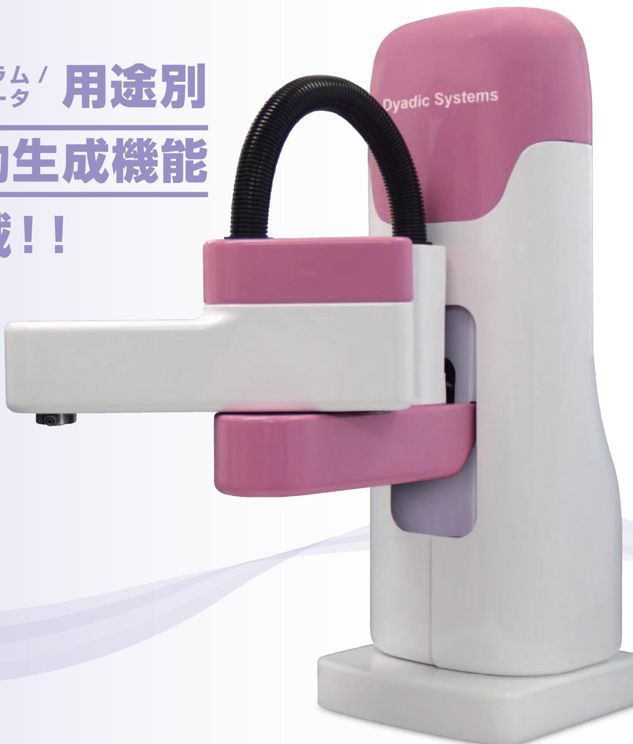
本製品は、モータ定格 80W 以下のサーボモータを使用しておりますので 産業用ロボット からは除外され JIS B8433-1/2:2015 (ISO 10218-1/2) の対象にならず、安全柵の規制はありませんが (厚生労働省告示第 51 号)、安全柵を必用とする産業用ロボットを協働ロボットとして使用する場合に要求している項目のうち、**Method4:Power and force limiting(力と圧力の制限)** においても 技術仕様書 ISO/TS 15066 に準拠させています。リスクアセスメントにより危険の恐れがなくなると評価できる場合 (ISO 12100:2010)、安全教育が不要で協働ロボットとして使用可能です。
