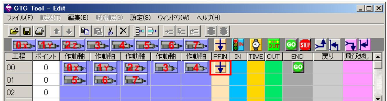
5軸を超える軸の同時移動動作を指定する場合にも、このアイコンを使用します。
