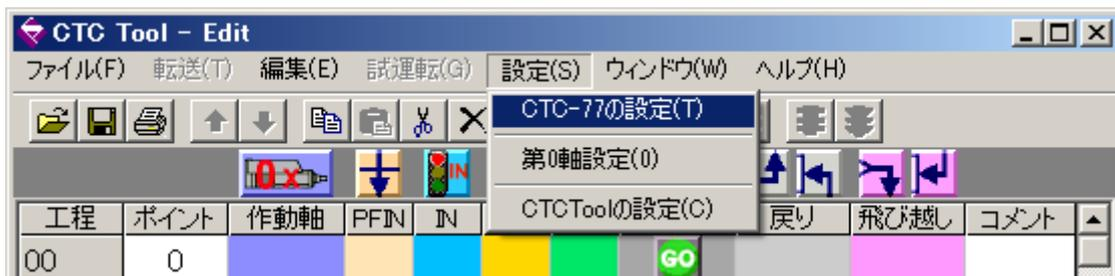
設定画面が開きますので、ここで設定します。設定後は必ず6項(データのアップロード／ダウンロード)で説明したデータのダウンロード(PC ⇒ CTC-77)を実行して下さい。
