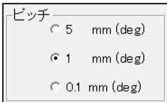
ボタンをクリックすれば、ロボットアームは指示された方向へ選択したピッチ（距離）だけ移動します。
