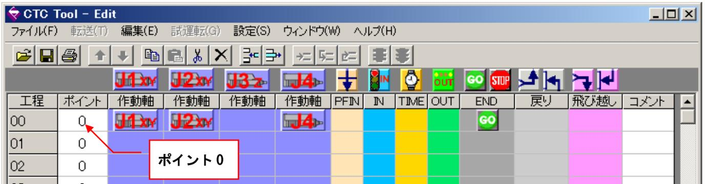
下のプログラムは、上下軸の 第3関節(J3)を【ポイント0】へ移動させるプログラムです。
