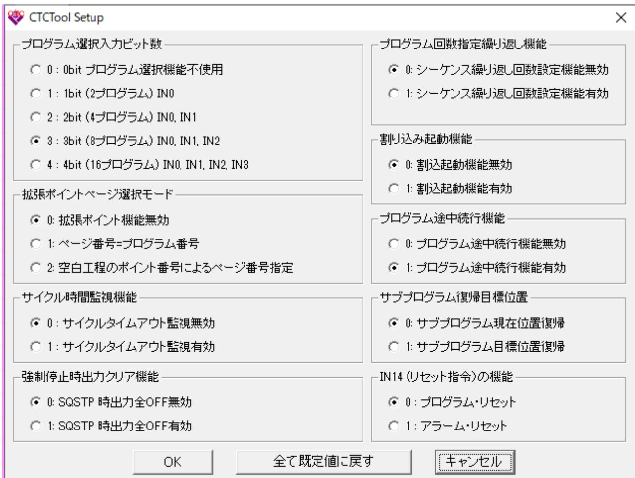
設定後は必ず トップ画面に戻り【ロボットにダウンロード】をクリックし ロボットにデータを保存して下さい。
