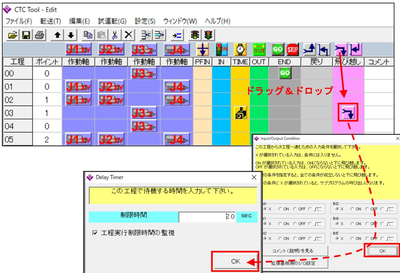
最後に 飛び越し先指定アイコン
