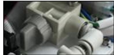
正面から見て、左側の切換弁 は 反時計方向に回し つまみ を 横 にして下さい。
