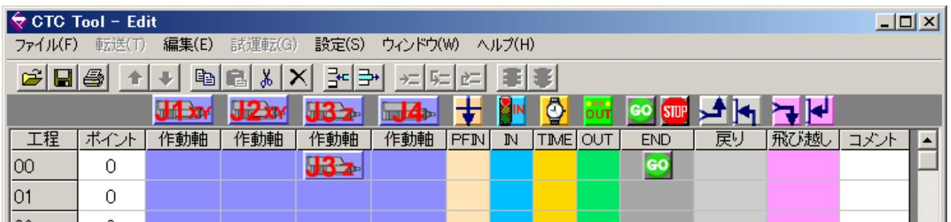
下のプログラム内容は、工程 00 で、上下軸の 第3 関節(J3) が【ポイント 0】へ移動後、工程 01 で ロボットアーム が 【ポイント 0】へ移動するプログラムです。
