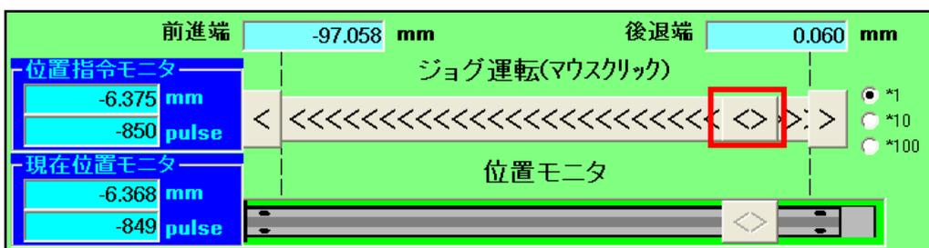
マウスで << <> >> を【 約-20mm 】までドラッグ してください。メカシリンダのロッドも同時に動きます。
