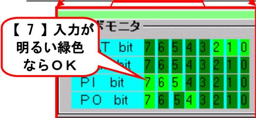
非常停止入力 (PI bit の 7) が OFF (暗い緑色) の場合は、平行接続ケーブル (RP9100-□□□の茶色線、又は、RP9120-□□□の紫色線) の ILK 信号線を 0V へ接続して下さい
